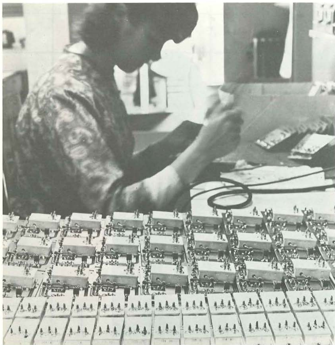
Johansson UHF kanalen- en kanaalgroepversterkers worden in verzilverde, weervaste doosjes gemonteerd. Het geheel gaat in een waterdicht plastic huis.
