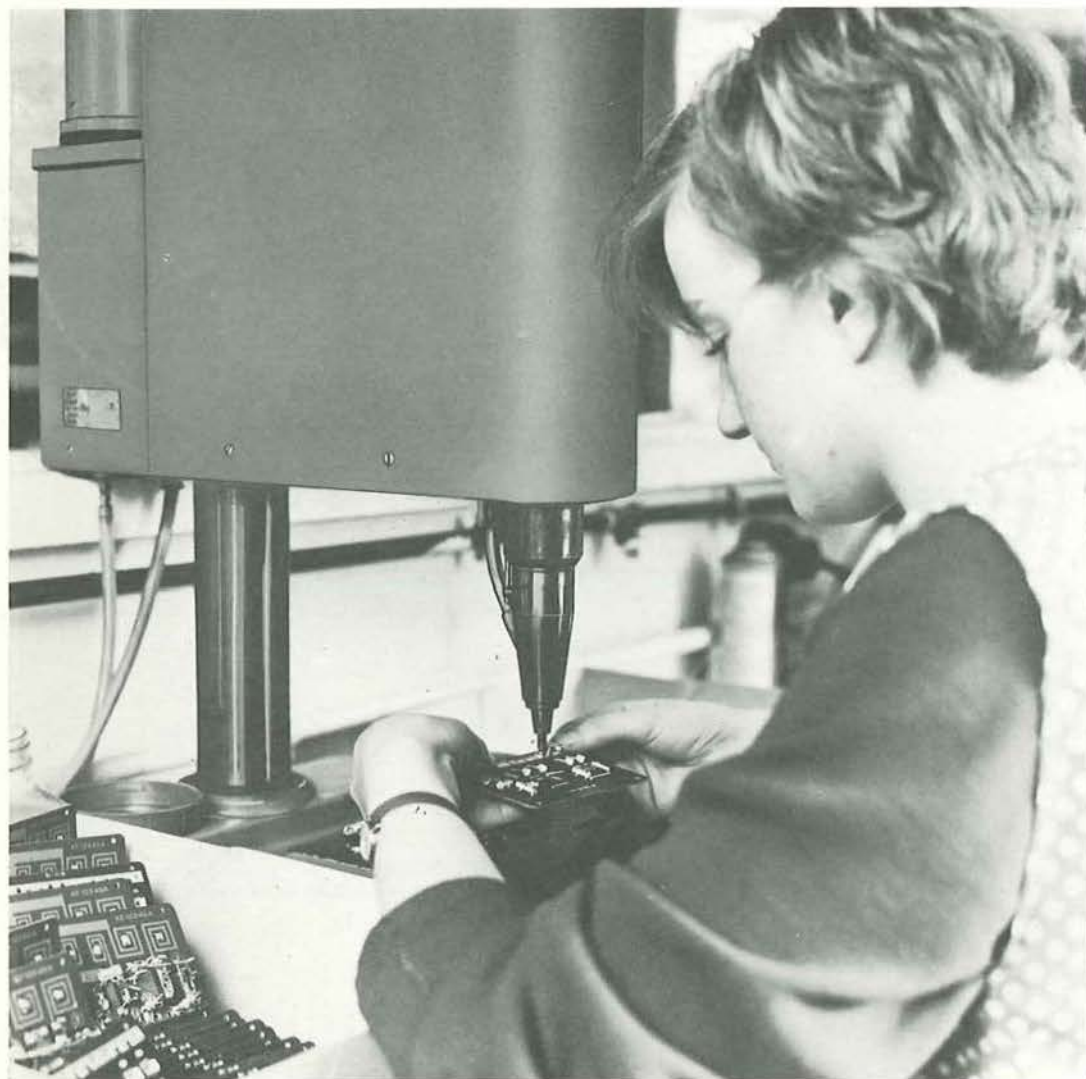
Miljoenen vijzen werden door deze moderne schroefindraaimachine met automatische toevoer reeds verwerkt.
