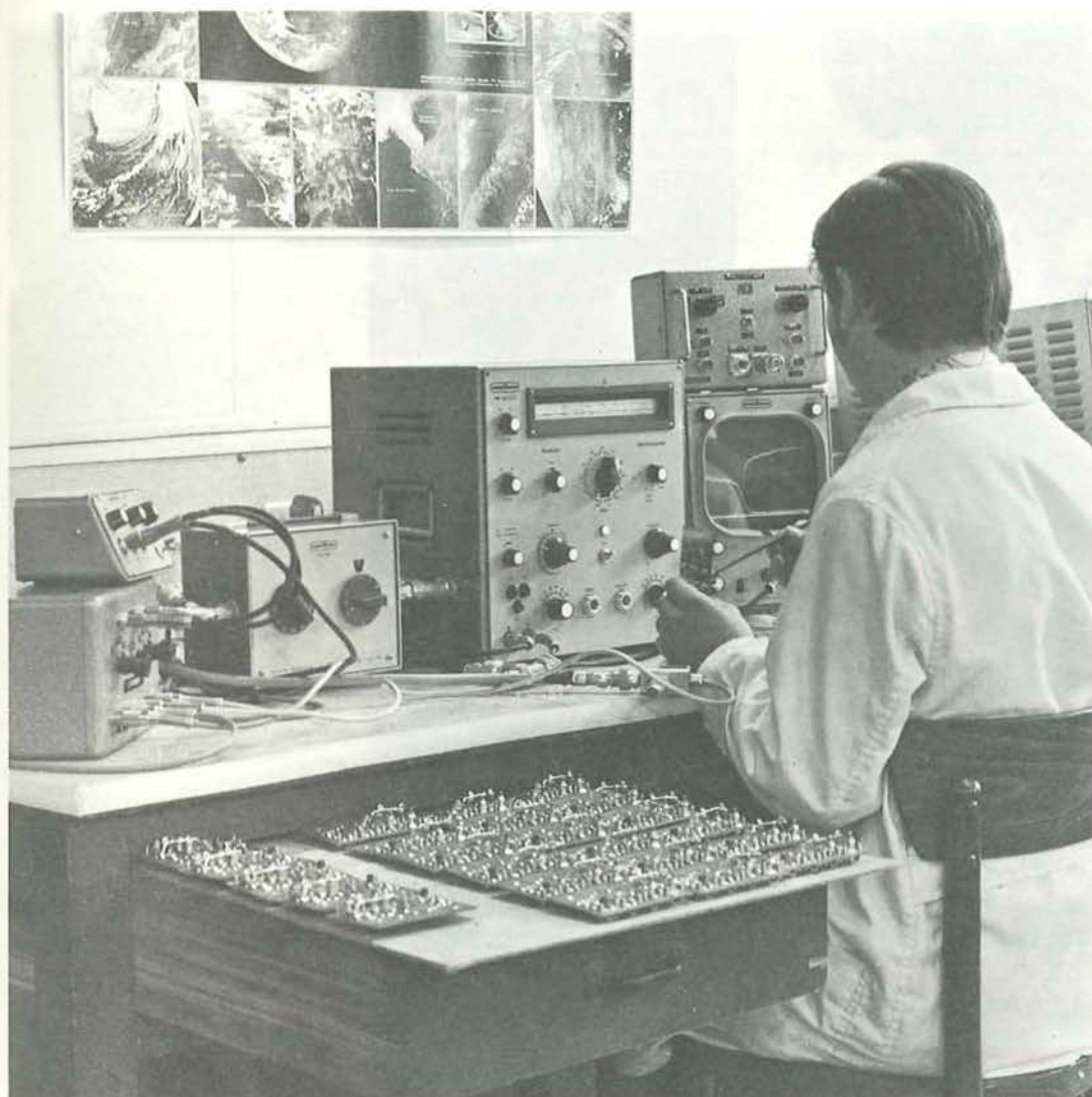
Kanalenfilters worden nauwgezet afgeregeld en op doorlaat en reflectie getest.
