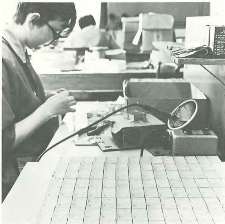
Vóórmontage van de verzilverde doosjes voor de transistorversterkers.
