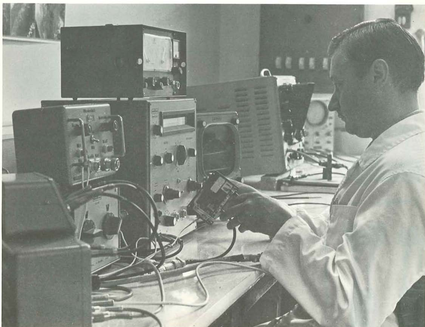
Moderne apparatuur, speciaal voor de afregeling van actieve en passieve vierpolen ontworpen waarborgen een konstante kwaliteit.
