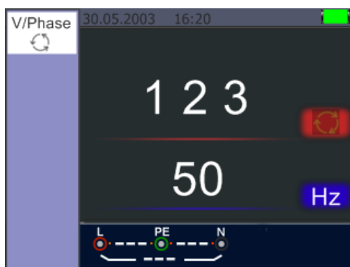
Richtige Phasensequenz L1, L2, L3
